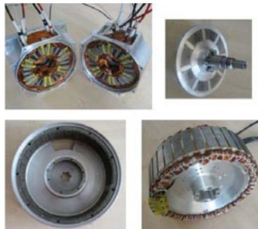
Moteur synchrone à aimant permanent réalisé
